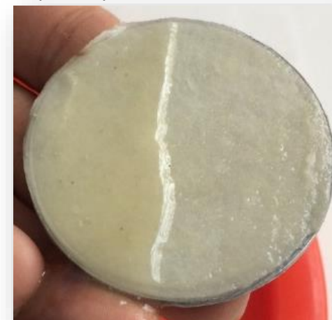
Фильтрационная корка Фильтр-пресс ΔР=7,5 атм.
